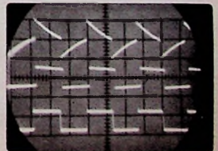
Afb. 15. Het hoogdoorlaatfilter beïnvloedt de 'dakvorm' van vierkantspulsen.
